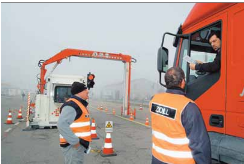
Mit Hilfe dieses Gerätes können die Ladungen von LKW's erfasst und auf einem Bildschirm sichtbar gemacht werden. Das erspart lästiges Ein- und Ausladen und erleichtert die Kontrolle. swb-Bild: frö
