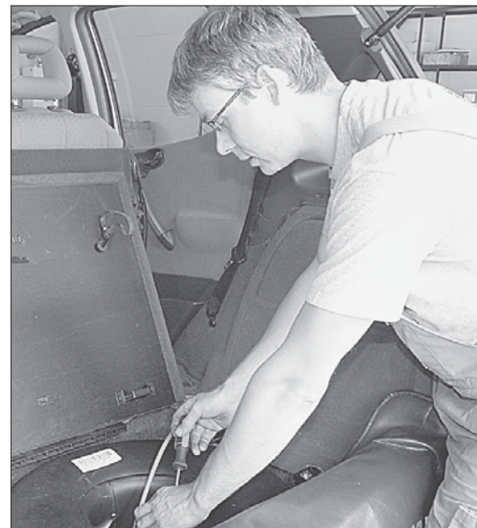
Im Heck des jeweiligen Fahrzeugs wird der Tank für das umweltschonende Autogas fachmännisch installiert. swb-Bild: frö
