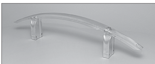
Ein bei Alcan Automotive Structures in Gottmadingen gefertigtes Chhrash-Management-System wird künftig in die neuen Modelle der C-Klasse von Mercedes Benz eingebaut. swb-Bild: Alcan
