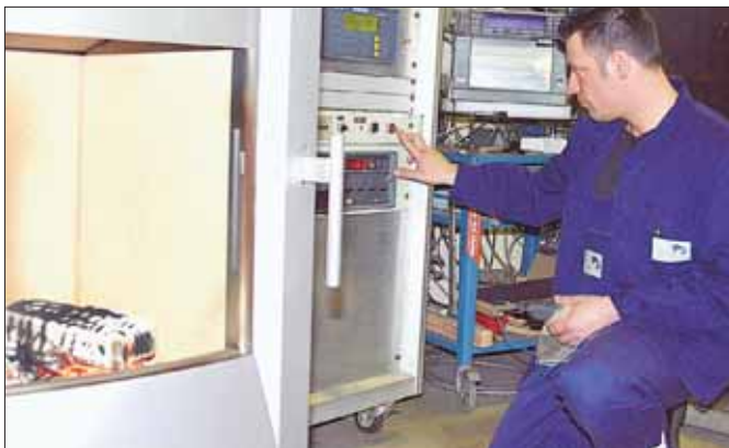
Auch offene Kamine werden vor der Markteinführung oder Inbetriebnahme bei Einzelanfertigungen auf das Emissionsverhalten untersucht.
