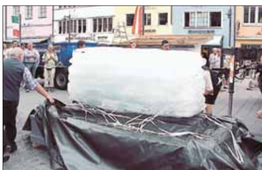
In vier Wochen sind von diesem Eisblock nur 338,5 Kilo geschmolzen. Eine beeindruckende Demonstration für Wärmedämmung.
