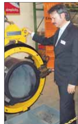
Geschäftsführer Achim Schneider an einem speziellen portablen Schneidegerät, mit dem selbst Pipelines sauber abgetrennt und nachher verschweisst werden können.
