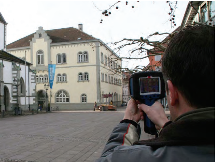
Klaus Marko, Energieberater der Stadtwerke Radolfzell, beim Thermografie-Check vor dem Rathaus in Radolfzell
