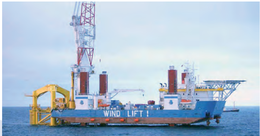
Das Montageschiff wird durch Stelzen am Meeresboden abgestützt um Montagearbeiten durchzuführen.
