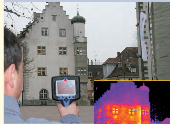
Klaus Marko – Energieberater der Stadtwerke beim Wärmebrückencheck am Österreichischen Schloßchen.
