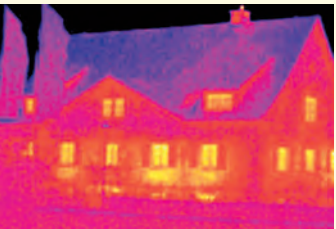
Die gelben Bereiche zeigen deutlich den Wärmeverlust, hier besonders die Heizkörper unter den Fenstern.
