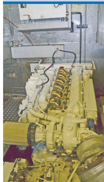
Motor: Der 500-PS-Motor der MS Seestern. Normale Fahrtgeschwindigkeit ist 14 km/h, Höchstgeschwindigkeit 28 km/h.
