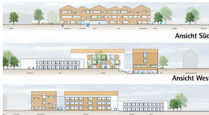
Die Ansichten einer möglichen Sanierung der Eichendorffschule.
