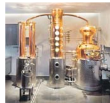
Die Brennkessel der Stahle-mühle. sub-Bild: Archiv
