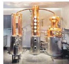
Die Brennkessel der Stahlmühle. sub-Bild: Archiv
