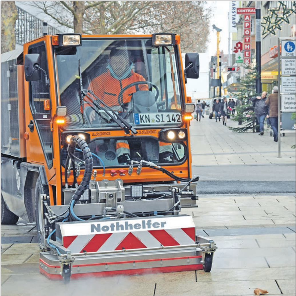
Ein neues Reinigungsfahrzeug wurde vor kurzem bei der Stadtreinigung in Betrieb genommen. Das Gerät, das auf den Namen Cleaner N15 hört, eignet sich bestens für die Reinigung von Fußgängerzonen, Parkhäusern, Ölsuren und Kunststoffbahnen auf Sportplätzen. Darüber hinaus entfernt es auch Kaugummis. Der Schmutzwasserbehälter fasst rund 1.500 Liter. In einer Stunde schafft es der Cleaner, rund 1.000 Quadratmeter Fläche zu reinigen. Dabei wird eine umweltfreundliche Reinigungsflüssigkeit und heißes Wasser mit einem Druck von bis zu 300 bar auf die Oberfläche aufgetragen und abgesaugt. Das Fahrzeug ist klein, wendig und kommt fast überall hin. Vier Mitarbeiter der Stadtreinigung sind mit dem neuen Reinigungsgerät unterwegs. Beim Fototermin saß Alexander Gross-Beschle am Steuer.
