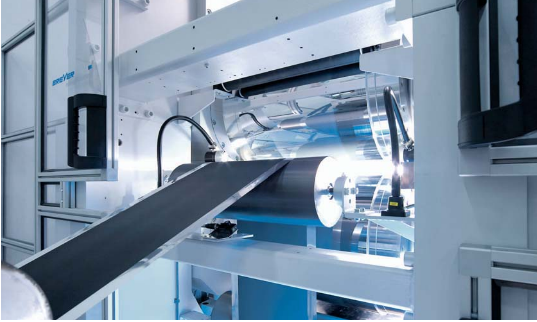
In einem »Kalendar« werden zuvor aufgetragene Mineralien komprimiert. Aus ihnen lassen sich später Lithium-Ionen-Batterien herstellen. Schon vor zehn Jahren wurde die Maschine von Breyer entwickelt, jetzt entwickelt sich dank Förderung des Wirtschaftsministeriums der Markt dafür.
