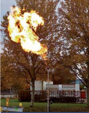
Kontrolliertes „Abfackeln“ von Erdgas, um den Druck konstant zu halten
