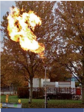
Kontrolliertes »Abfackeln« von Erdgas, um den Druck konstant zu halten
