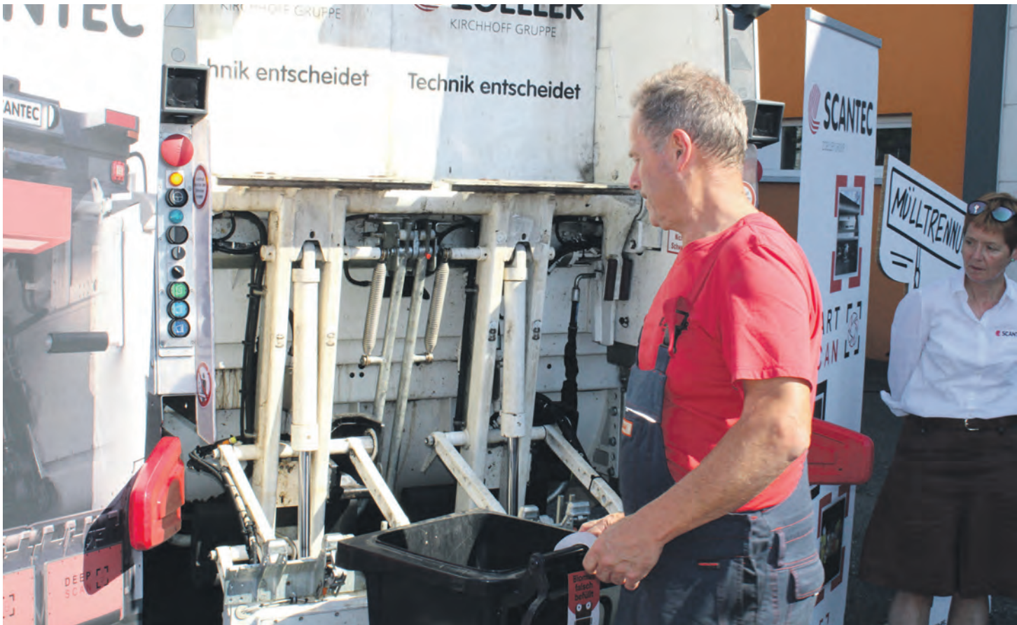
Otto Stooß demonstriert, wie das Scan-System an dem Müllsammelfahrzeug funktioniert und wann eine Tonne nicht geleert wird.
