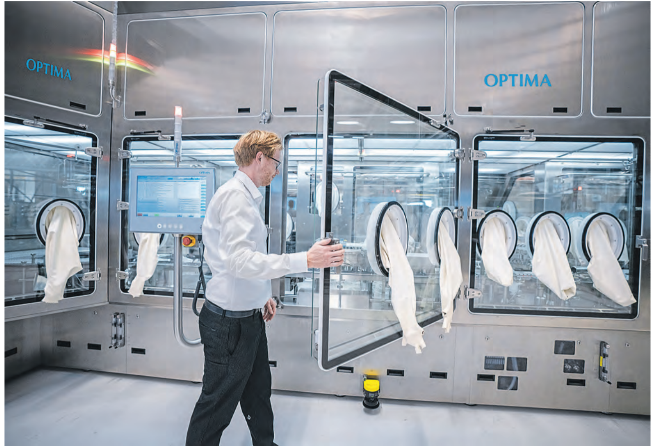
Mit Isolatoren aus Radolfzell, Gefriertrocknern aus Mornshausen und Abfüllanlagen aus Schwäbisch Hall kann OPTIMA pharma Kunden vollendete Turnkey-Lösungen anbieten. Foto: © OPTIMA
