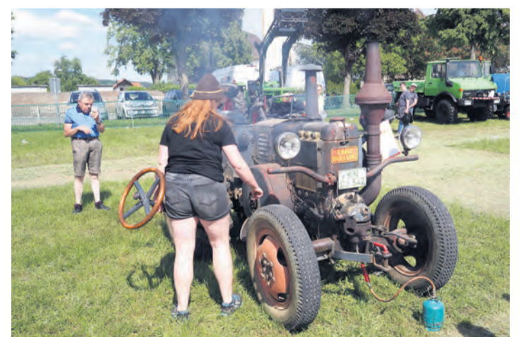
Das ein Lanz-Bulldog von 1941 mit dem Lenkrad angeworfen werden muss und der Motor vorher noch mit einer Glühlampe auf Temperatur gebracht wird, war ein viel beachtetes Schauspiel auf dem Oldtimertreffen.
