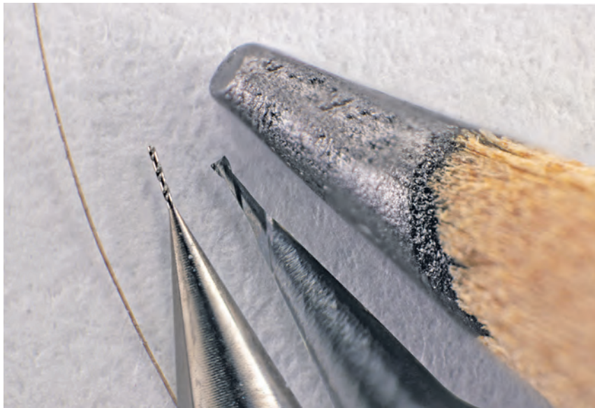
Zu bearbeitendes Material und Werkzeuge sind oft mit bloßem Auge kaum zu erkennen. Manchmal handelt es sich um Drähte, die nur halb so dick wie ein Menschenhaar sind. Zur Veranschaulichung v.l.: Haar, Bohrer (0,1mm), Fräser (0,2mm), Bleistiftspitze
