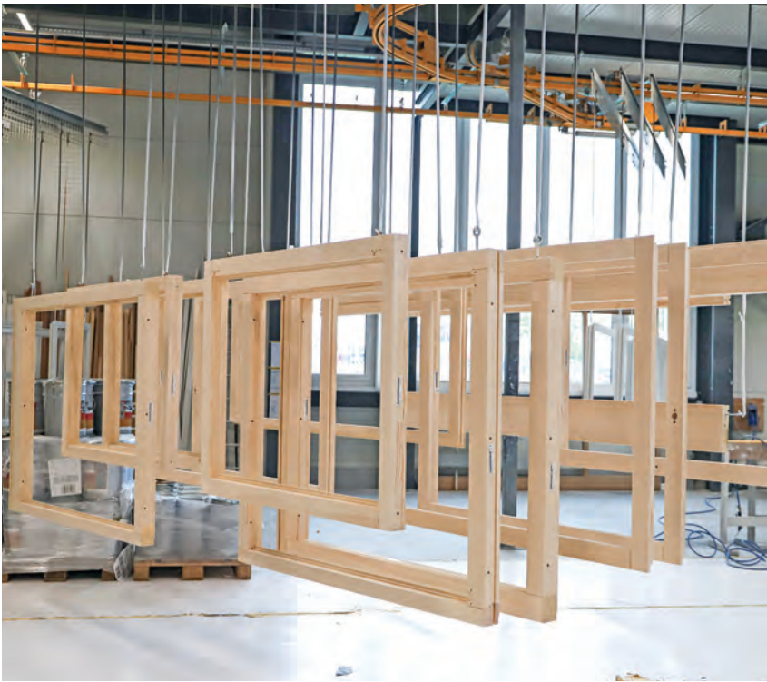
„Rahmen-Prozession“: Holzfensterrahmen fahren durch den Flutkanal, werden vom Lackierrobotern lackiert und erhalten ihre besondere Qualität durch speziell lange Trocknungszeiten zwischen den Lackiervorgängen. Foto: ©Kim Kroll, Wochenblatt
