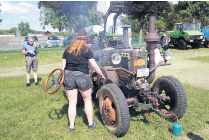
Das ein Lanz-Bulldog von 1941 mit dem Lenkrad angeworfen werden muss und der Motor vorher noch mit einer Glühlampe auf Temperatur gebracht wird, war ein viel beachtetes Schauspiel auf dem Oldtimertreffen.
