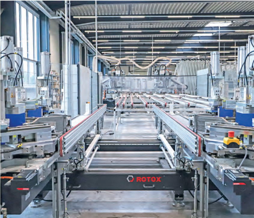
Auf der hochmodernen Produktionslinie für Kunststofffenster werden vier einzelne Profilstäbe gleichzeitig zu Flügel- und Blendrahmen verschweißt. Nach der Kühlzeit werden die Teile automatisch übernommen, verputzt und endbearbeitet. Foto: ©Kim Kroll, Wochenblatt
