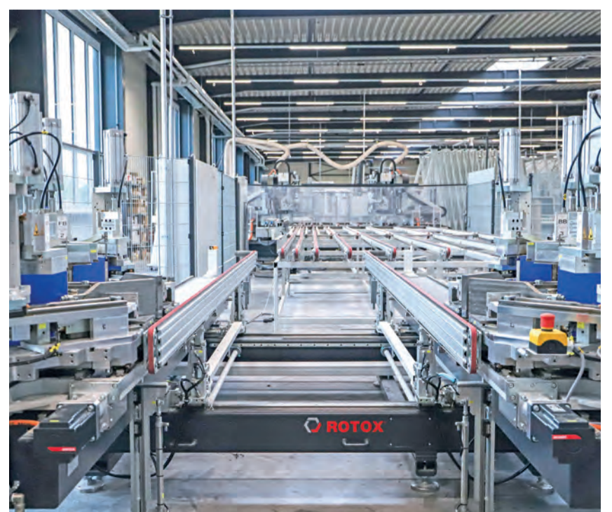
Auf der hochmodernen Produktionslinie für Kunststofffenster werden vier einzelne Profilstäbe gleichzeitig zu Flügel- und Blendrahmen verschweißt. Nach der Kühlzeit werden die Teile automatisch übernommen, verputzt und endbearbeitet. Foto: ©Kim Kroll, Wochenblatt
