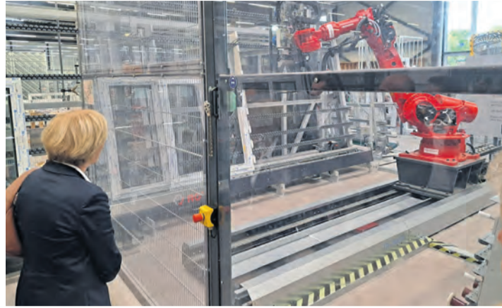
Für das Einlegen der Scheibe in den Rahmen ist kein Mitarbeiter nötig - eine Maschine übernimmt das. swb-Bild: Sebastian Ridder
