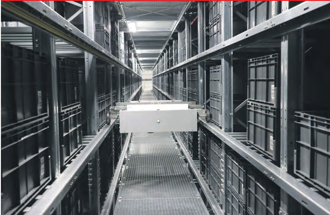
Auf 17 Ebenen fährt jeweils ein Shuttle-Fahrzeug, das die benötigten Boxen automatisch zum Ausgabepunkt bringt.
