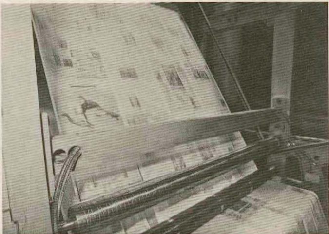
Schneller als das Auge sehen kann, flitzen Papierbahnen durch die großen Rotationsanlagen des Druckzentrums Konstanz, wo das Wochenblatt in der Nacht von Dienstag auf Mittwoch gedruckt wird. Am Ende der Maschine ist das Wochenblatt bereits fertig aus den Bahnen zugeschnitten und gefaltet, wie es in die Briefkästen kommt.
