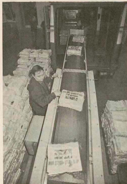
Über die Fließbänder gelangen die Wochenblätter aus dem Druckzentrum Konstanz direkt in die Lieferwagen des Vertriebs, die die Zeitung an die Verteilungspunkte im Verbreitungsgebiet bringen. Auch hier regiert der Computer. Jedes der Päckchen ist bereits beim Zusammenschnüren mit der Adresse und dem Namen des Austrägers versehen worden.
