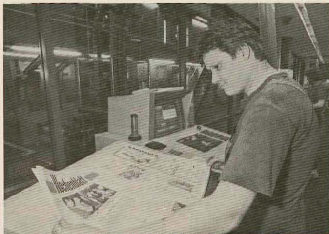
Der Druckvorgang des Wochenblattes kann dank modernster Drucktechnik von einer zwar kleinen, aber hochqualifizierten Crew bewältigt werden. Über ein computergesteuertes Pult wird die riesige Rotationsanlage »geführt«. Aus dem laufenden Druckvorgang werden immer wieder Exemplare des Wochenblatts herausgenommen und geprüft.
