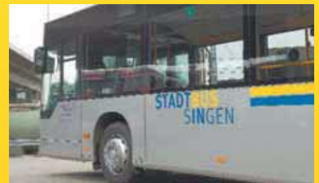
So sieht er aus, der neue Stadtbus vom Typ MB »Citaro« in edlem Silber und mit den Singener Stadtfarben versehen. Im inneren ist der Bus durchgehend ebenerdig. Ein stehend eingebauter Motor an der Hinterseite des Busses macht dies möglich.
