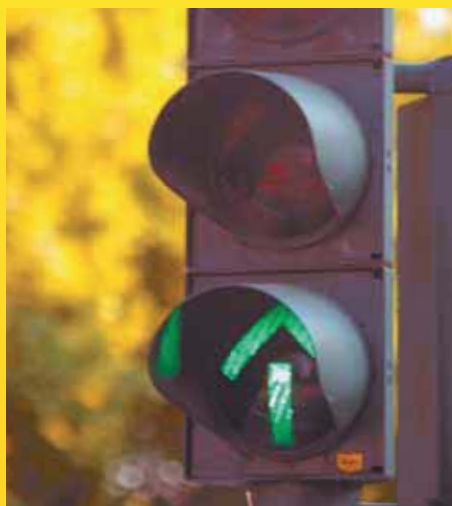
Durch GPS-Technik haben die neuen Stadtbusse künftig immer die »Grüne Welle«. Das System, über das der Bus der Ampel seine Ankunft ankündigt, wird nach und nach an den Knotenpunkten der Stadtbuslinie ausgebaut.
