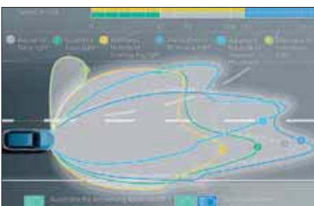
Viele Details machen das Autofahren sicherer. Bei ersten neuen Modellen von BMW geht das Licht nach dem Vorbild des legendären DS von Citroen jetzt auch mit in die Kurve.
