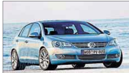
Eine neue Studie des VW Golf TDI Hybrid soll dank der Kombination aus Diesel, Elektromotor und 7-Gang-Getriebe nur noch 3,4 Liter Diesel auf 100 Kilometer verbrauchen.
