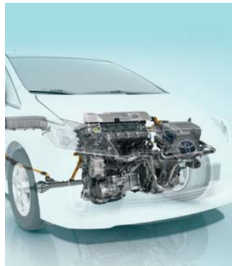
Eine Menge Zukunftstechnologie unter der Haube hat der Prius: Der Motor links, in der Mitte oben der Inverter, unten das Getriebe und der Generator.
