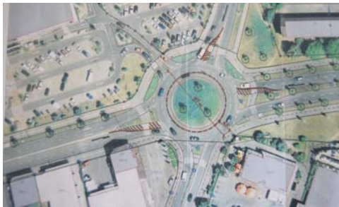
Der Kreisverkehr mit seinen fünf Ausgängen ist seit einigen Jahren auf eine Fahrspur begrenzt worden.
