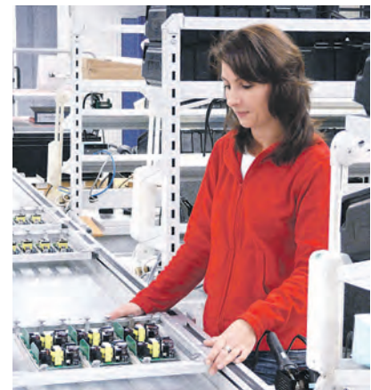
Eine Mitarbeiterin von inpotron bei der Arbeit am Band. Sie überprüft die Steckverbindungen auf einer Platine. Gute Augen und Fingerspitzengefühl sind für den Job von Vorteil.
