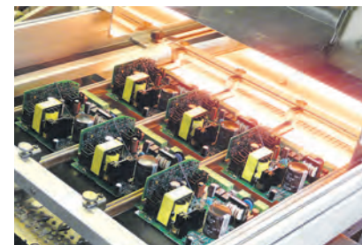
Am Ende des Fließbandes kommen die Teile in der Lötwellen an. Dort werden sie miteinander verbunden.
