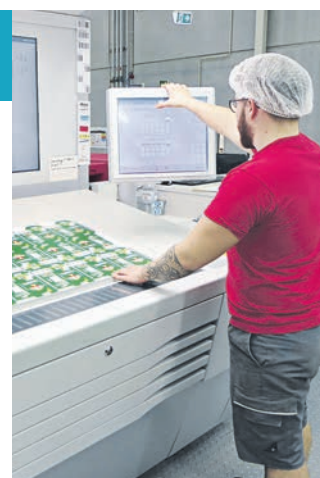
Er macht Papierverpackungen farbig: Manuel Mallinger, Medientechnologe Druck im 2. Lehrjahr an der Heidelberger 6-Farben-Offset Maschine. swb-Bild: Cüven
